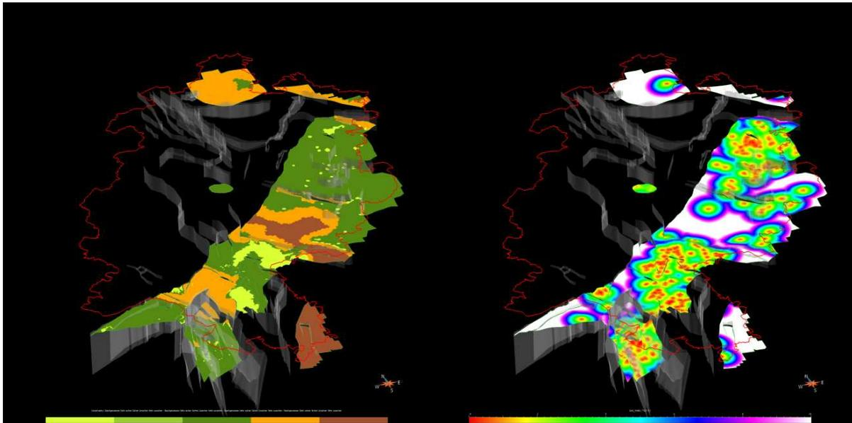
Fläche Top Rotliegend (in grau: Modellstörungennetz): links die Klassifikation der Unsicherheit; rechts: mit der Eigenschaft Distanz zu Bohrinformationen. So ist auf den ersten Blick ersichtlich, wie weit der nächstgelegene Eingangsdatensatz für jeden Punkt auf der modellierten Fläche ist.
