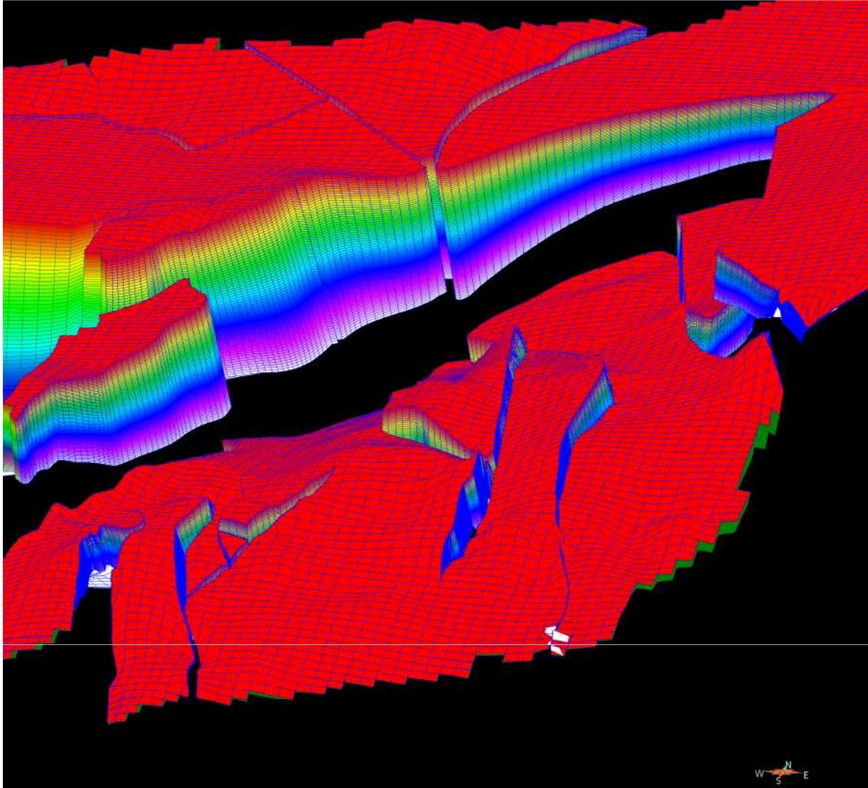
Blick aus südlicher Richtung auf das Rotliegend-Formationsgrid im Bereich des Oberrheingrabens (3 fache Überhöhung). Das Grid passt sich den modellierten Schichtoberflächen und Störungsflächen gut an.
