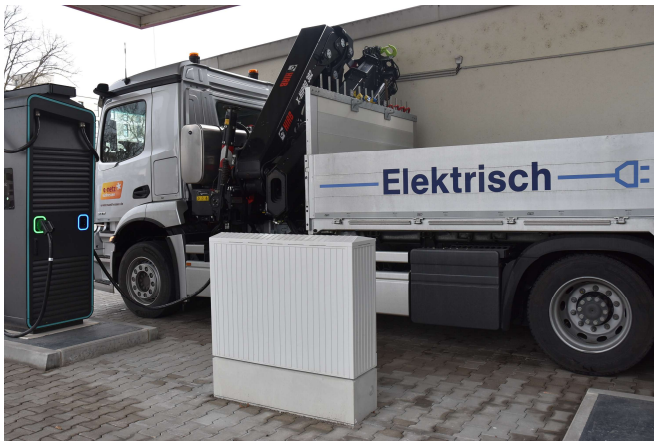
Abbildung 11 Beispiel einer E-Ladesäule für Lastkraftwagen (Foto: e-netz Süd Hessen AG)
