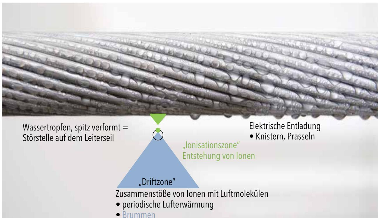
**Abb. 1:** Mechanismen der Geräuschentstehung von breitbandigen hochfrequenten und tonalen tieffrequenten Schallemissionen an Leiterseilen [24].
