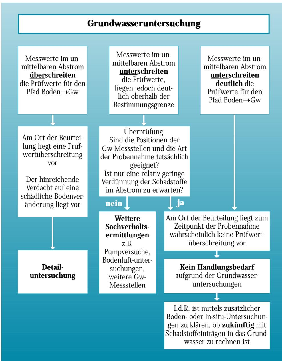
**Abb. 4:** Orientierende Untersuchungen - Bewertung von Grundwasseranalysen bei der Sickerwasserprognose
