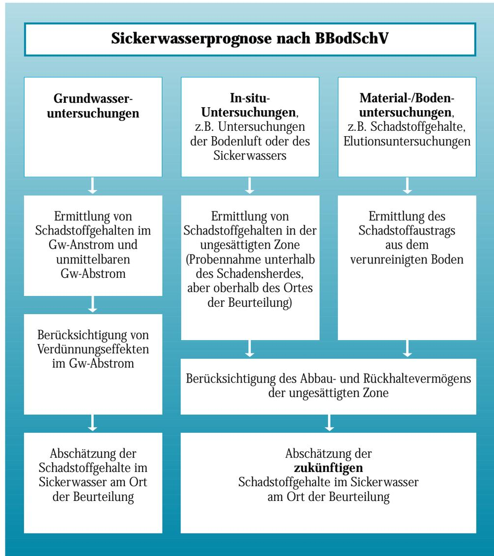
**Abb. 3:** Möglichkeiten der Sickerwasserprognose
