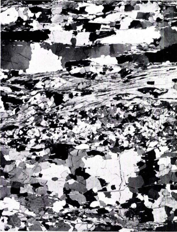
Abb. 25. Dünnes Gneissband con der Zusammensetzung Granat + Biotit + Muscovit + Plagioklas + Quarz im mittleren Bildteil wird oben und unten durch serizitquarzitische Lagen begrenzt. Das abgebildete Gneissband ist im oberen Teil außerordentlich muscovitreich, im unteren ebenso plagioklasreich und entsprechend glimmerarm. — Gretenberg, Stbr. an der Straße gegenüber Strötzbach (Kahl), Dünnschliff SM 2026 (bc-Schnitt), Vergr. 9×, + Nic.
