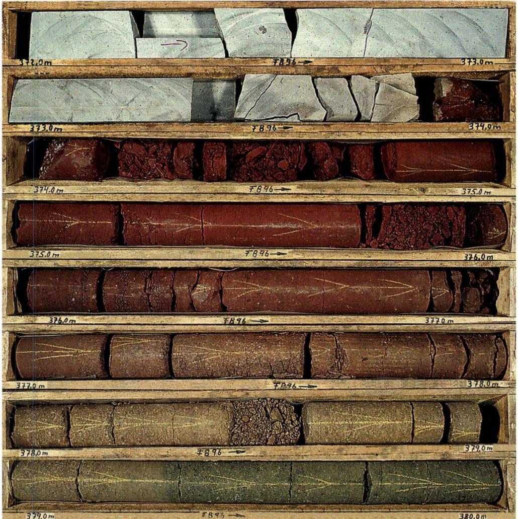
**Abb. 9.** Kernfolge zwischen 372 und 380 m u. Gel.: Unterer Grenzbereich des Trachytkörpers mit deutlicher thermischer Beeinflussung (Rotfärbung) der liegenden basaltischen Aschen-/Lapillituff-Folge.
