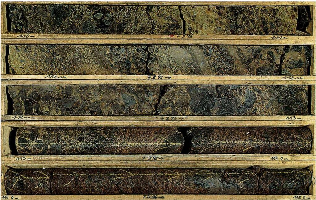
Abb. 4. Kernfolge zwischen 110 und 115 m u. Gel.: Schlackenagglomerat mit angedeuteter, schräg (zum Bohrkern) einfallender Schichtung.
