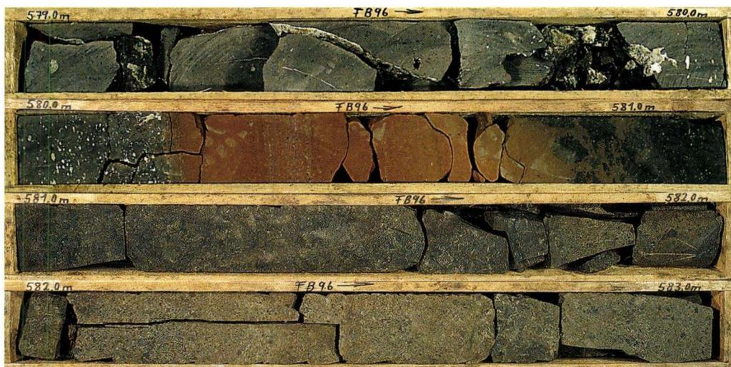
**Abb. 16.** Kernfolge zwischen 579 und 583 m u. Gel.: Ti-reicher Alkaliolivinbasalt-Lavastrom über thermisch beeinflussten (rotgefärbten) Aschentuffen (mit Akkretionären Lapilli zwischen 580,30 und 580,45 m u. Gel.) über dunkelgrauer Lapilli- und Aschentuff-Folge.
