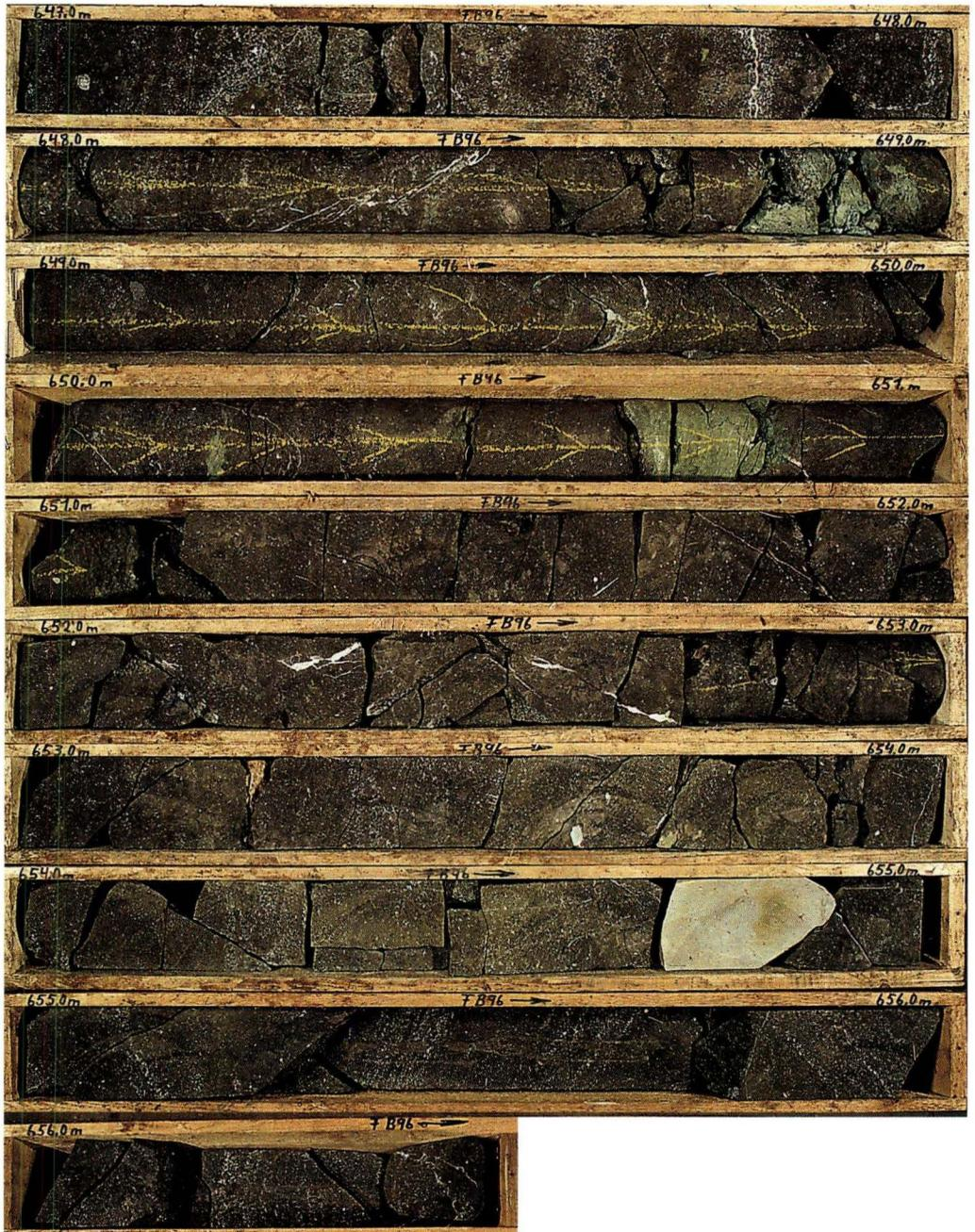
**Abb. 18.** Kernfolge zwischen 647 und 656,50 m u. Gel. (Endteufe): Untererer (erbohrter) Bereich der Massenstromablagerung (wie in Abb. 17) mit größeren Tonklasten (Rupelton; u.a. bei 648,90 m und 650,75 m u. Gel.) und größerem Kalksteinklast (Oberer Muschelkalk) zwischen 654,70 und 654,90 m u. Gel.
