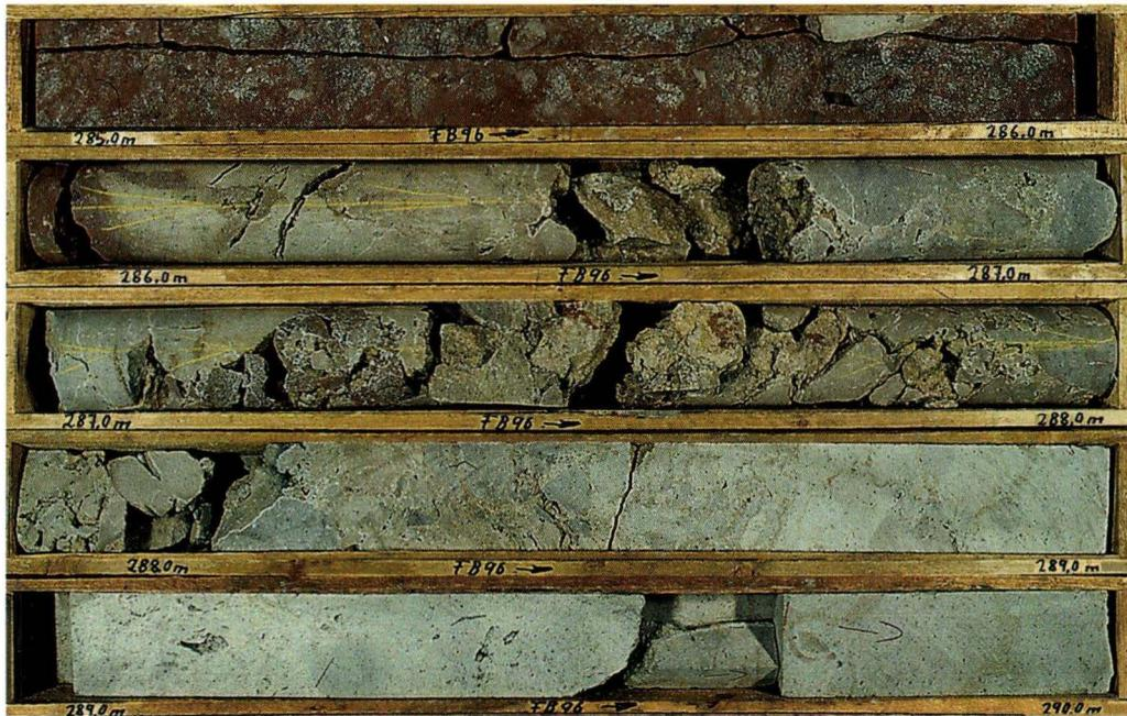
Abb. 8. Kernfolge zwischen 285 und 290 m u. Gel.: Basaltisches Schlackenagglomerat überlagert die brekziöse Dachzone eines fast 90 m mächtigen Trachytkörpers (Lavastrom oder exogener Dom).
