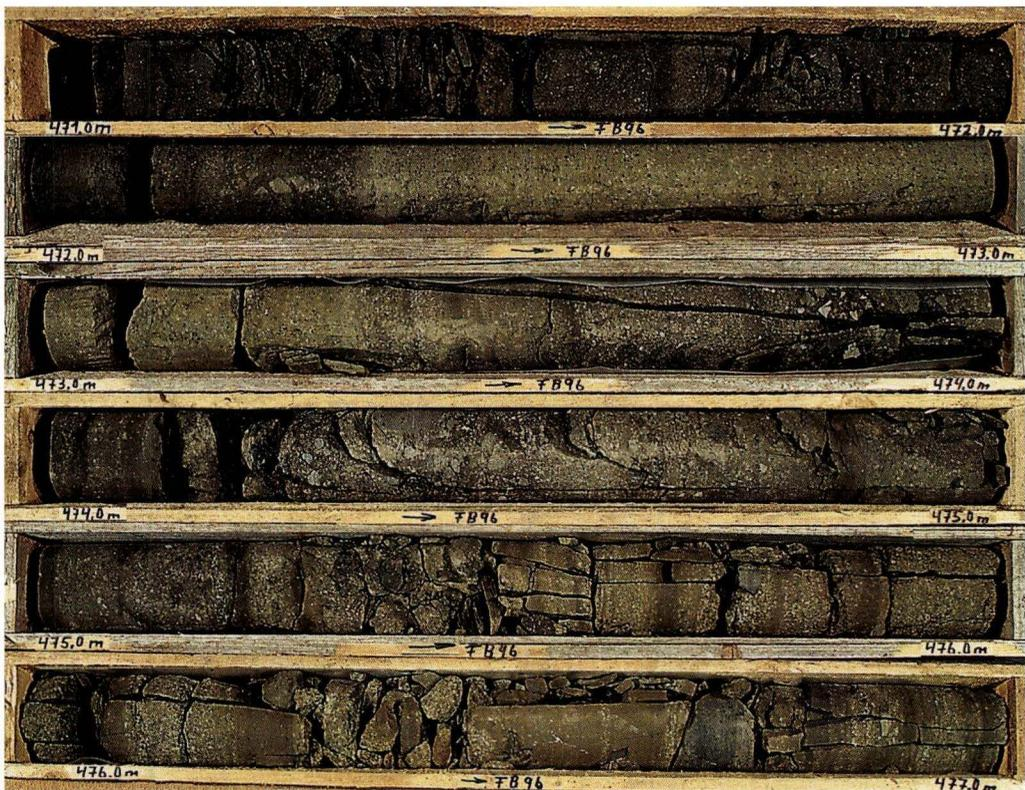
**Abb. 13.** Kernfolge zwischen 471 und 477 m u. Gel.: Gut geschichtete Surge-Ablagerungen in Form vulkanitlithoklastenreicher Lapilli- und Aschentuffe; Aschentuff-Lagen z.T. mit Akkretionären Lapilli (s. Abb. 14).
