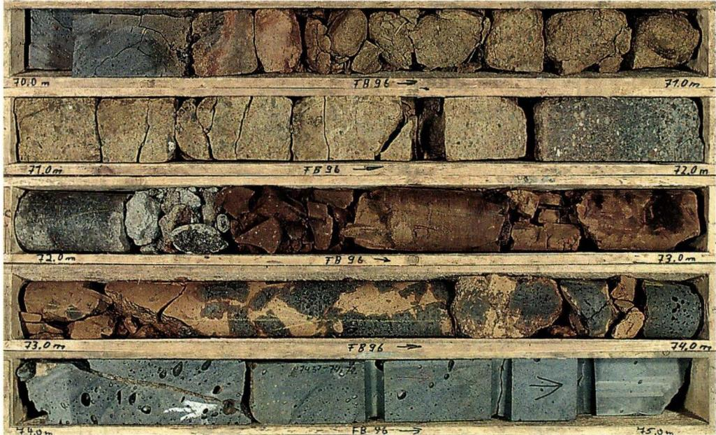
Abb.3. Kernfolge zwischen 70 und 75 m u. Gel.: Aschen- und Lapillituff-Folge zwischen zwei basanitischen Lavastromen; die Dachbrekzie des liegenden Lavastroms ist mit eingesedimentiertem Aschentuff durchsetzt.
