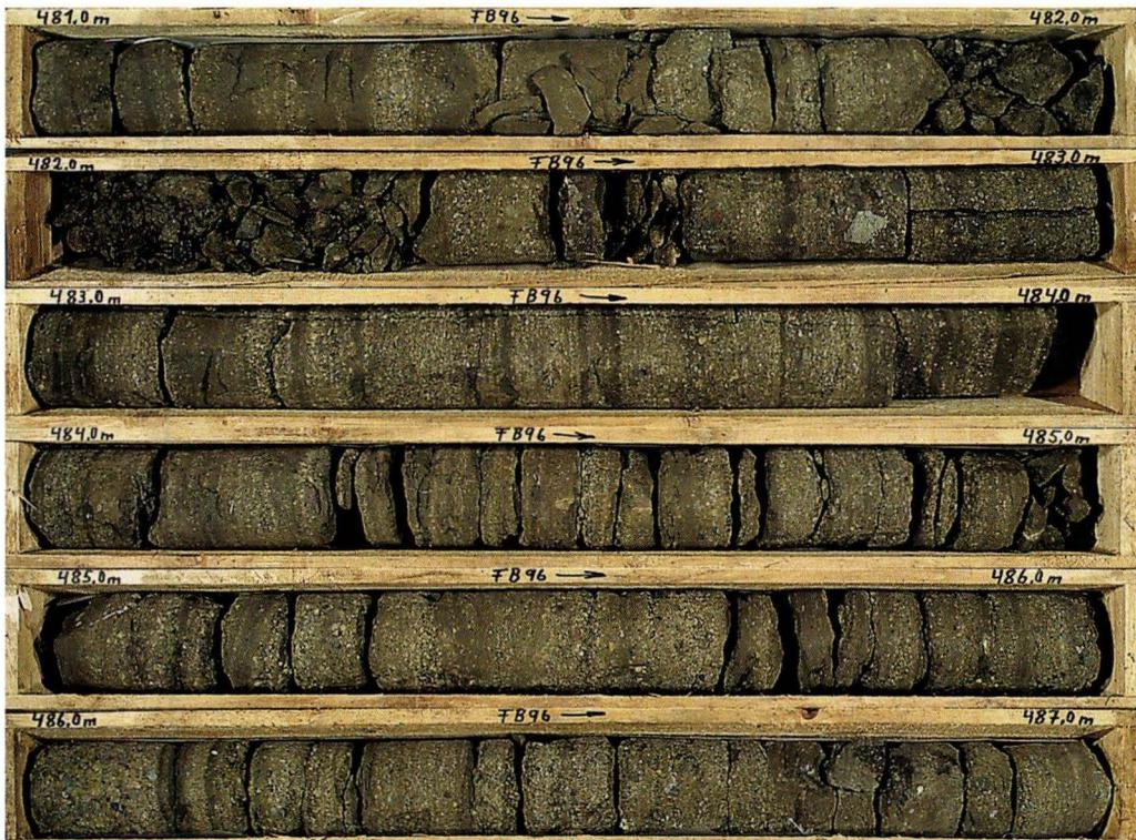
Abb. 15. Kernfolge zwischen 481 und 487 m u. Gel.; Gut geschichtete Surge-Ablagerungen in Form vulkanitlithoklastenreicher Lapilli- und Aschentuffe.
