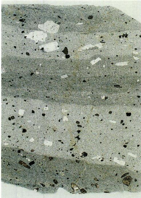
**Abb. 12.** Grenz- und Mischbereich bei 453,10 m u. Gel. von Amphibol > Klinopyroxen > Plagioklasporphyrischem Hawaiiit (dunkel) und Plagioklas > Amphibol > Klinopyroxen porphyrischem Latit (hell) im Dünnschliff (|| Pol.).
