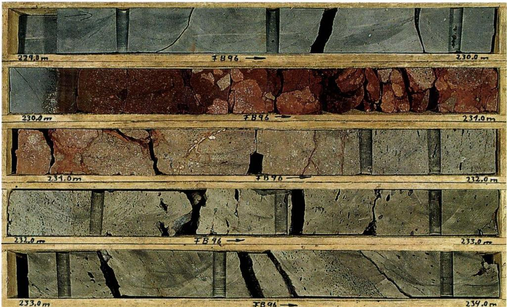
**Abb. 6.** Kernfolge zwischen 229 und 234 m u. Gel.: Thermisch beeinflusste (rotgefärbte) Aschentuffe zwischen Lavaströmen aus Alkaliolivinbasalt (oben) und Tholeiitischem Basalt (unten), in dessen Dachzone von oben Aschentuff einsedimentiert ist.
