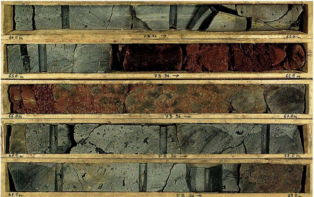
**Abb. 2.** Kernfolge zwischen 64 und 69 m u. Gel.: Zwei basanitische Lavaströme mit zwischengeschaltetem, thermisch beeinflusstem (rotgefärbtem) Aschentuff, der auch in die Dachbrekzie des liegenden Lavaströms einsedi- mentiert ist.
