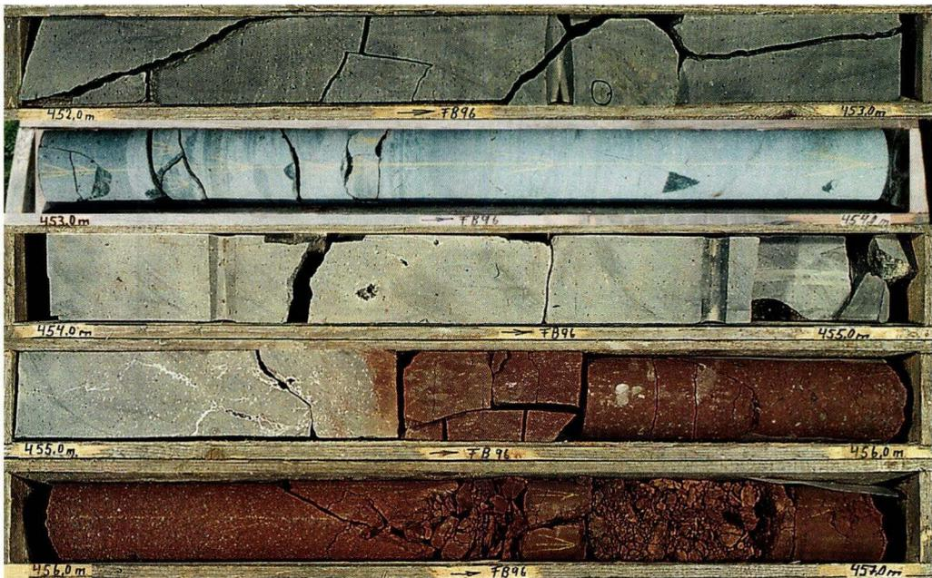
**Abb. 10.** Kernfolge zwischen 452 und 457 m u. Gel.: Unterer Teil des composite lava flow aus Hawaiiit (oben) und Latit (unten) über thermisch beeinflusster (rotgefärbter) Aschen-/Lapillituff-Folge; zum Grenzbereich bei 453,10 m u. Gel. s. Abb. 11 und 12.
