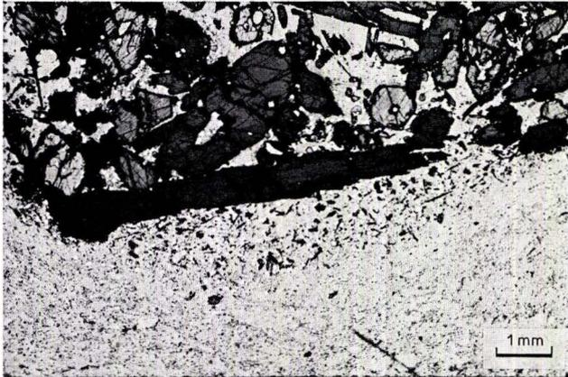
Abb. 20. Grobkörnige Schlieren aus Hornblende, Apatit und Alkalifeldspat im porphyrischen Trachyt der Brg. 1; Pr. 12197 (45,4 m u. Gel.), DS 18935.
