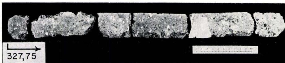
Abb. 56. Kernstücke aus der ? Schlammstrom-Ablagerung zwischen ca. 327,75 (328,50) und 329,80 (330,60) m u. Gel.; ungeschichteter und schlecht sortierter Gesteins-Lapilli-Aschentuff aus trachytischen (weißlich), sedimentären und basaltischen Gesteinsfragmenten; Brg. 2.
