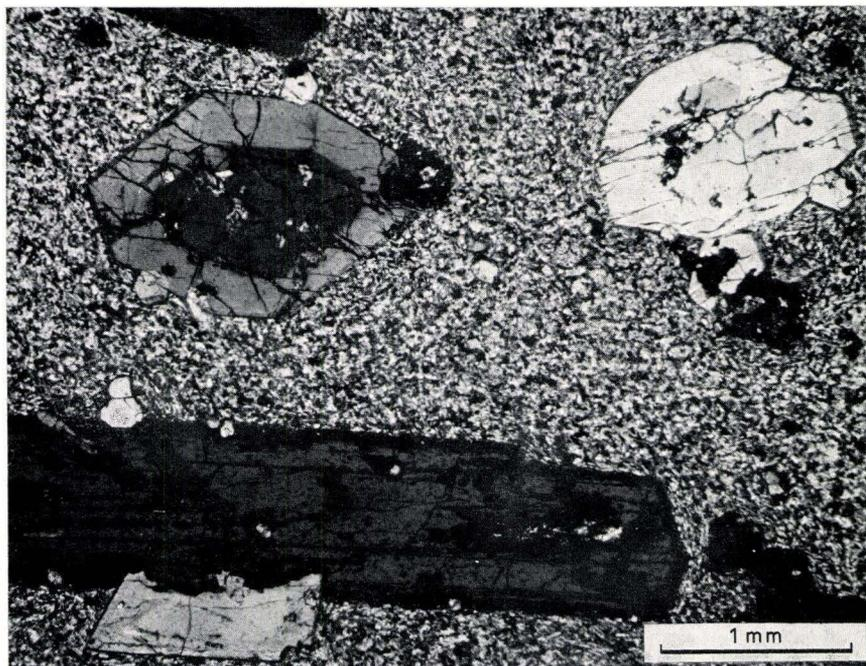
Abb. 66. 2 Klinopyroxen-Einsprenglinge [im porphyrischen Mugearit zwischen 303,2 (302,8) und 304,35 (304) m u. Gel. der Brg. 2/2 A] mit genau umgekehrten Entwicklungstrends von den Kern- zu den Randzonen: im linken Einsprengling Al- und Ti-Anreicherung und Si-Mg-Abnahme und im rechten Einsprengling Fe-Al-Ti-Verarmung und Si-Mg-Anreicherung [vgl. Tab. 2, Pr. 12117 (303,6 m u. Gel.; Brg. 2)].
