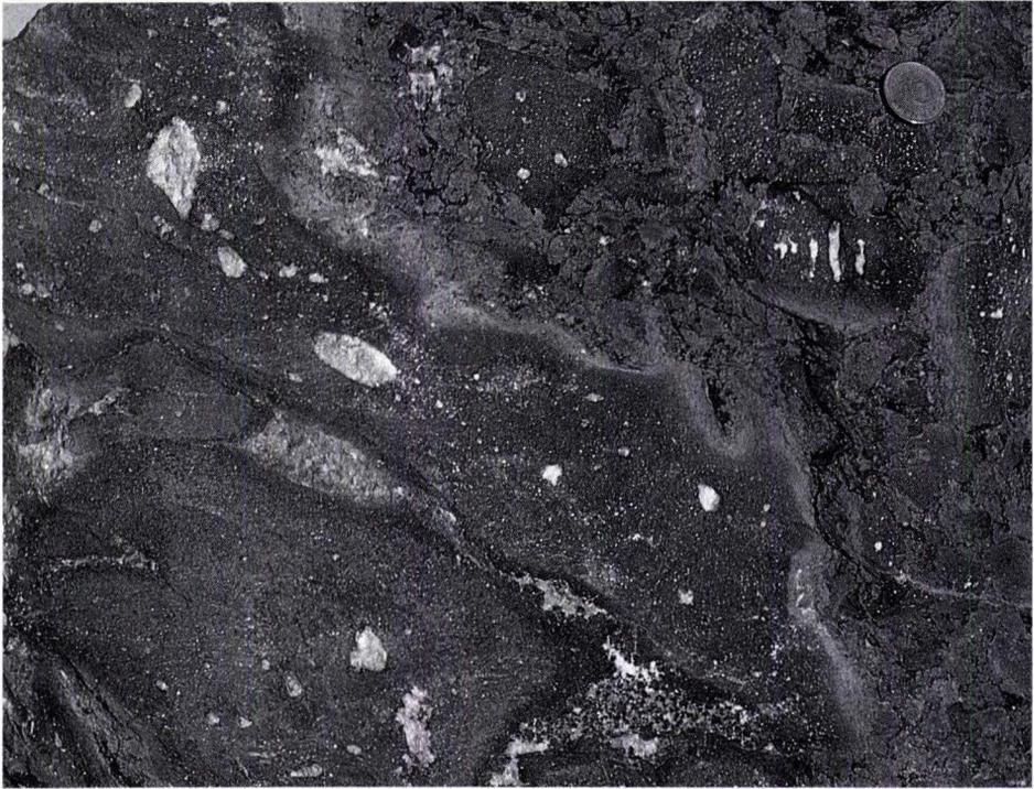
Abb. 26. Pillowfragmentbreccie aus größeren amöbenförmigen Lavakörpern (isolierte Minipillows) sowie deren Bruchstücken (dunkelgrau) und ehemals glasigen Hyaloklasten (hellgrau). Interpartikelraum mit Chloritzement (schwarz) gefüllt. Steinbruch 1 km NW Altenkirchen (Profil 34), mittlere Lahn-Mulde.
