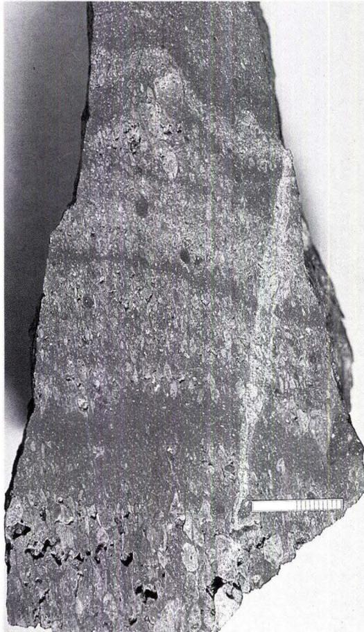
Abb. 6. High-density-Turbidit im Anschliff: Mächtigkeit der Lagen im cm-Bereich, Gradierung von Feinkies bis Grobsand. Lokalität wie Abb. 5.
