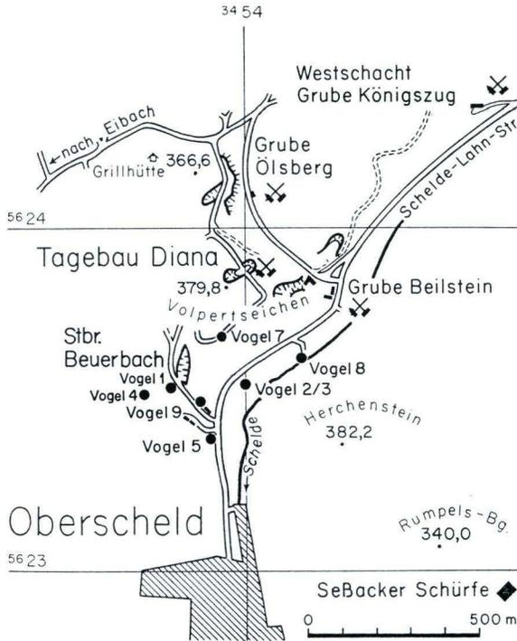
Abb. 1. Lage des Untersuchungsgebietes beim aufgelassenen Stbr. Beuerbach N Oberscheld östlich Dillenburg. Maßstab 1:20 000. Vogel 1-9 = Lagepunkte von Tiefbohrungen auf Eisenerz.
