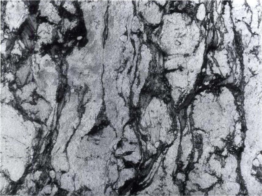
Abb. 3. Dünnschliffaufnahme eines für das Untersuchungsgebiet typischen Kataklastits: Zerleinerte Quarzaggregate und ausgeschmierter Biotit umfließen Feldspatprophyroklasten.
