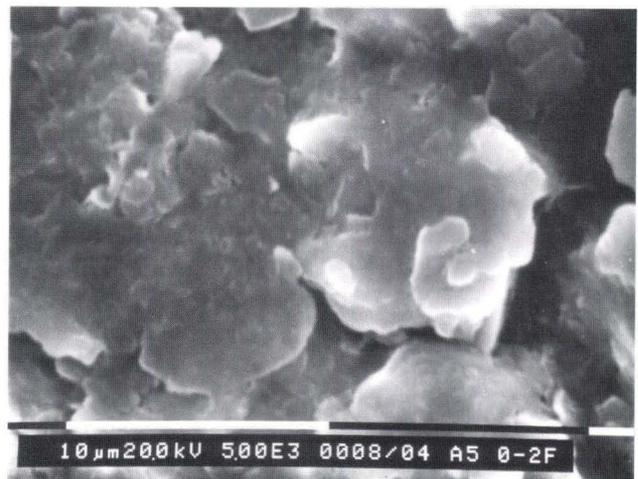
Abb. 36. REM-Aufnahme des basisch behandelten Tons, Vergrößerung ca. 5 000-fach. Deutlich sichtbar sind die Verklebungen der Clusters mit einer massigen Substanz.
