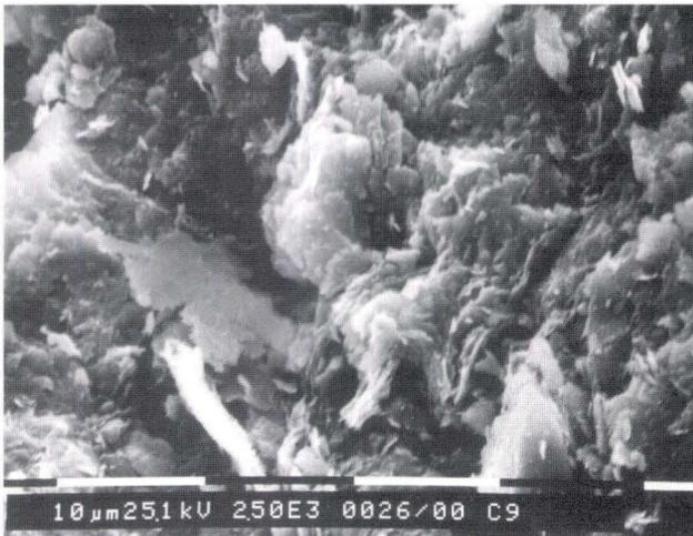
Abb. 38. REM-Aufnahme des sauer behandelten Tons, Vergrößerung ca. 2 500-fach. In der Mitte der unteren Bildhälfte ist die lockere Kartenhausstruktur deutlich erkennbar. Die Cluster liegen locker und ohne Bindemittel zusammen.
