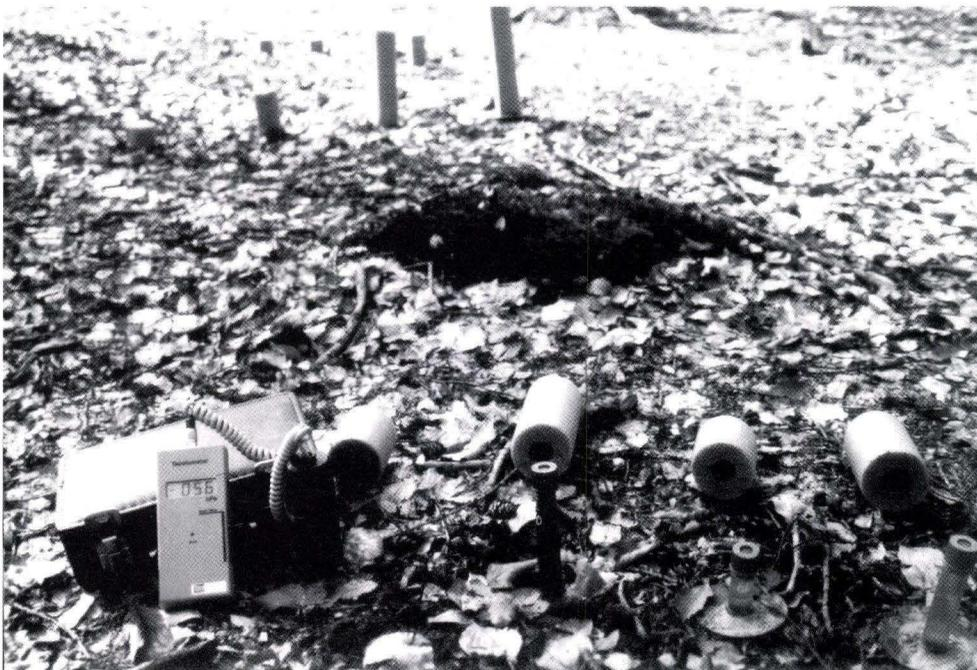
Abb. 4. Tensiometermessung im Gelände.
