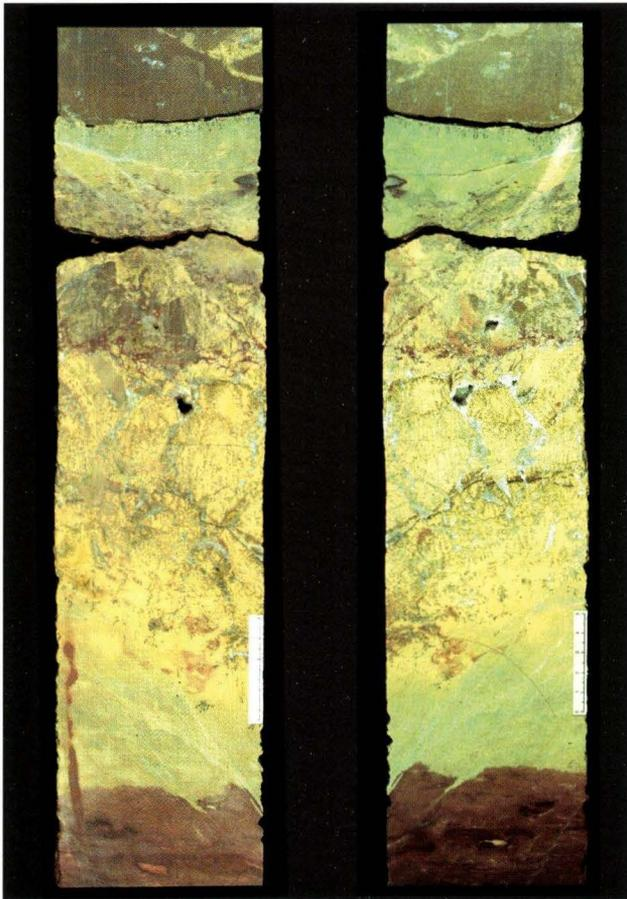
Abb. 6. Grenzhorizont zwischen T1r und A1Ca in der Bohrung A/99-BK1.
