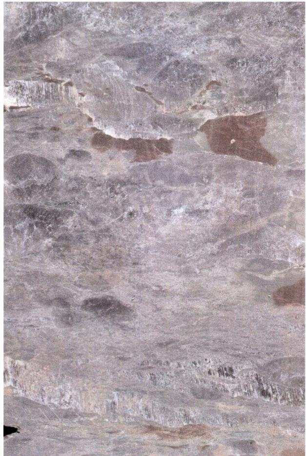
**Abb. 6.** Aufgearbeitete Tonklasten und eine Fasergipslage. Röt 2, Bohrung Borken K47, Teufe: 145,06–147,20 m, Bildbreite: 12 cm.
