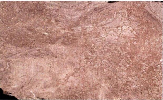
**Abb. 14.** Infolge der Entwässerung wurde das Sediment sekundär nahezu vollständig homogenisiert. Röt 1, Bohrung Borken K30a, Teufe: 26,60 m, Bildbreite: 12 cm.
