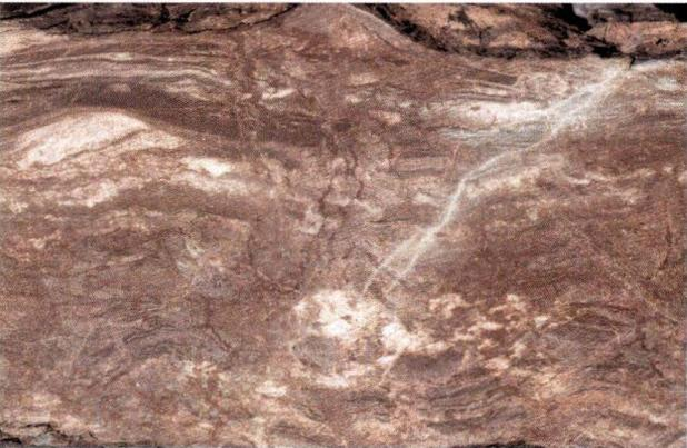
**Abb. 13.** Das Sediment ist durch Entwässerungsstrukturen stark geprägt. Röt 2. Bohrung Borken K47, Teufe: 156,50 m, Bildbreite: 12 cm.
