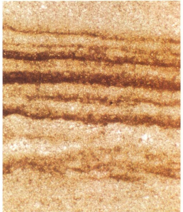
**Abb. 10.** Lamination ton- und dolomitreicher Schichten des Röt 4. Myophorien-Schichten, Dünnschliff, Bohrung Borken K 30a, Teufe: 14,80-15,00 m, Nicols: II, Bildbreite: 10 cm.
