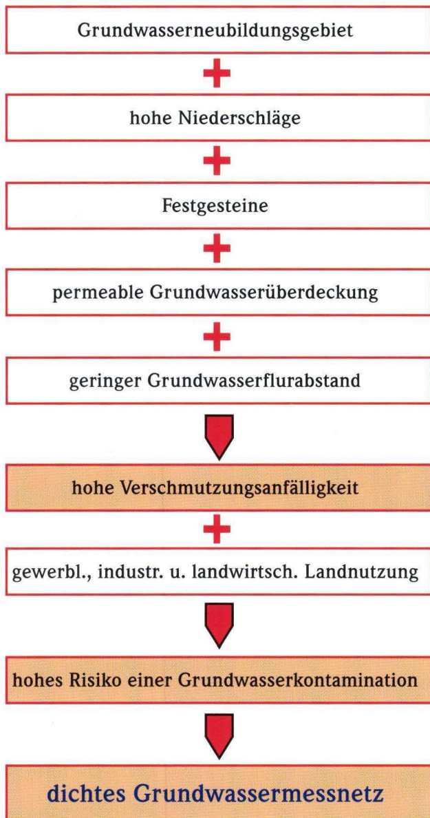
Abb. 5. Abhängigkeit der Messnetzplanung von Faktoren, die sich quantitativ und insbesondere qualitativ auf das Grundwasser auswirken.
