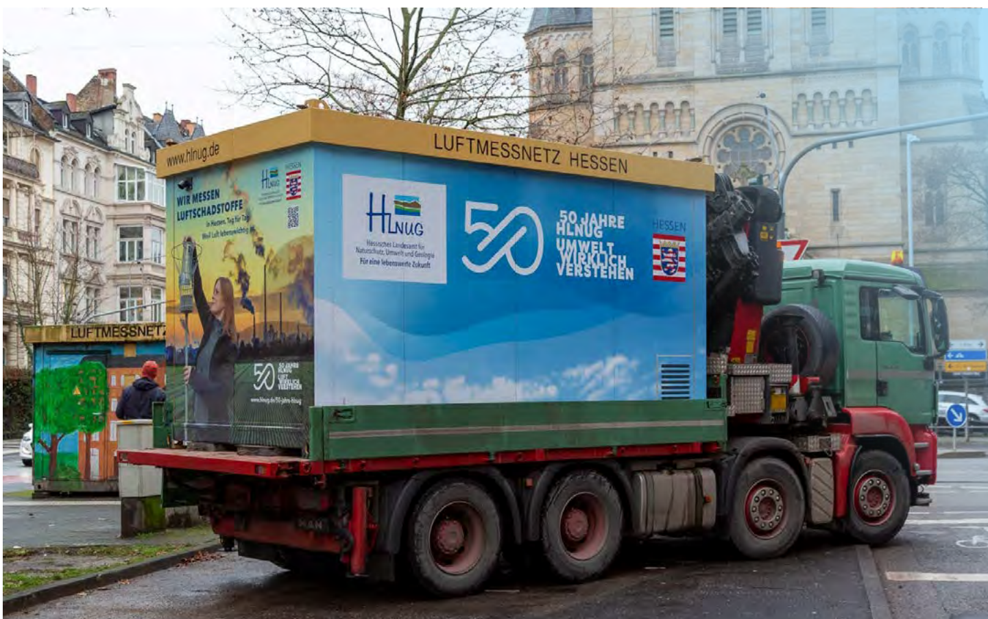
Abb. 1: Anlieferung des neuen Containers (Luftmessstation Wiesbaden Ringkirche) © HLNUG
