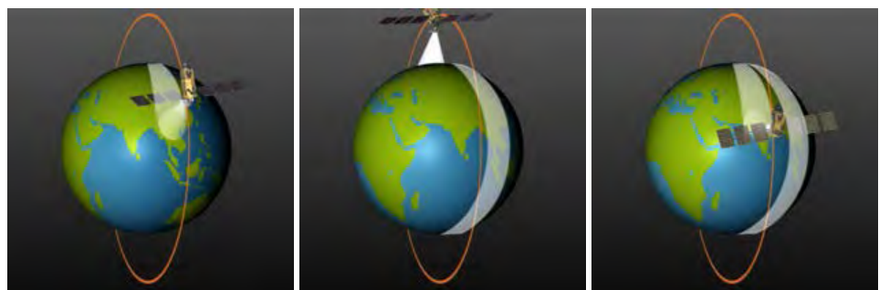
Abb. 1: Veranschaulichung des Low Earth Orbit mit polarer Umlaufbahn © DLR (CC BY 3.0)
