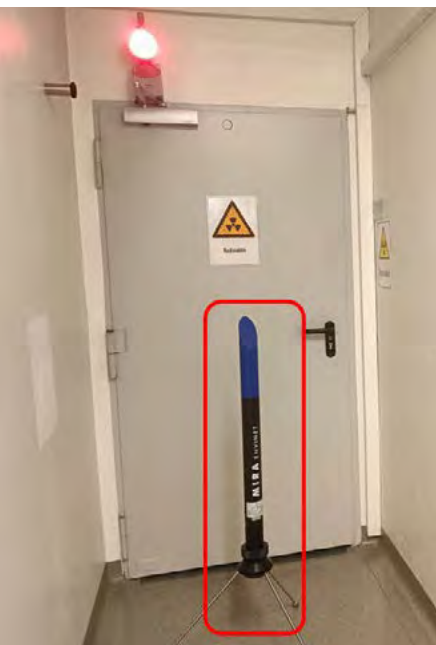
Abb. 4: Hier wird beispielhaft die Messung der Ortsdosisleistung während einer Patientenbehandlung bei einer Brachytherapie gezeigt. Die rot eingerahmte Messsonde zeichnet dabei die Messwerte auf.
