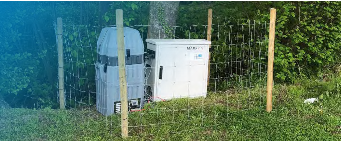
Abb. 4: Foto des Aufbaus eines automatischen Probennehmers am Gewässer zur Beprobung von Regenereignissen © Charlotte Franck/ HLNUG
