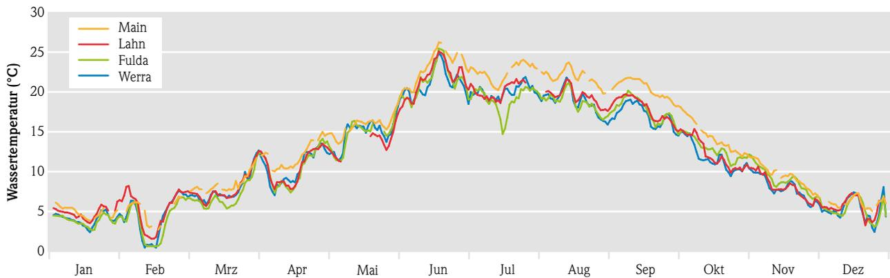
**Abb. 46:** Jahresganglinien der Temperaturmaxima im Jahr 2021 an den vier Messstationen Bischofsheim/Main, Oberbiel/Lahn, Wahnhausen/Fulda und Witzenhausen/Werra
