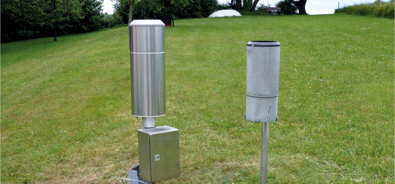
**Abb. 7:** Niederschlagsmessstelle Freiensteinau (links: Pluviometer, rechts: Hellmann-Messgerät) © HLNUG
