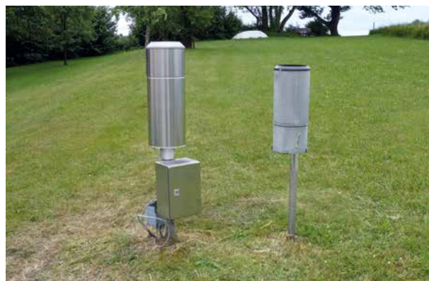
Abb. 6: Niederschlagsmessstelle Freiensteinau (links: Pluviometer mit kontinuierlicher hochauflösender Messung und Datenfernübertragung, rechts Hellmann-Messgerät, Tagesmessung durch einen Beobachter)
