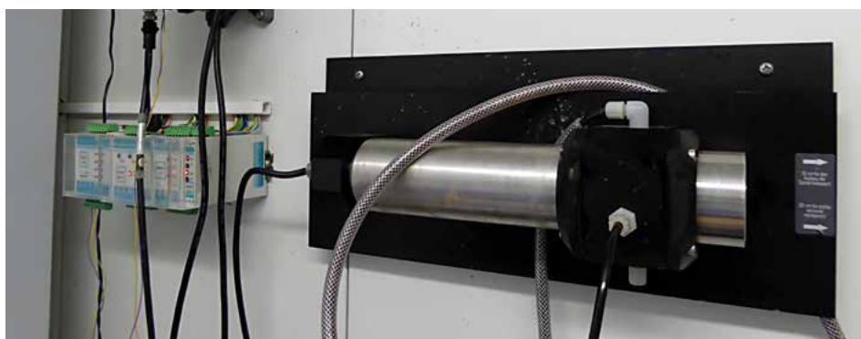
Abb. 44: a) Automatischer Probennehmer für Wochenmischproben b) kontinuierliche Nitratmessung in einer Messstation
