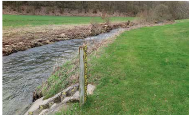
Abb. 15: Pegel Essershausen an der Weil, Gewässer mit Pegeltreppe, Stufenpegel
