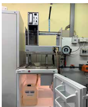
Abb. 44: a) Automatischer Probennehmer für Wochenmischproben b) kontinuierliche Nitratmessung in einer Messstation
