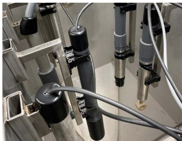
Abb. 37: Sonden zur kontinuierlichen Messung von pH-Wert, Sauerstoffgehalt, Trübung und elektrischer Leitfähigkeit © HLNUG
