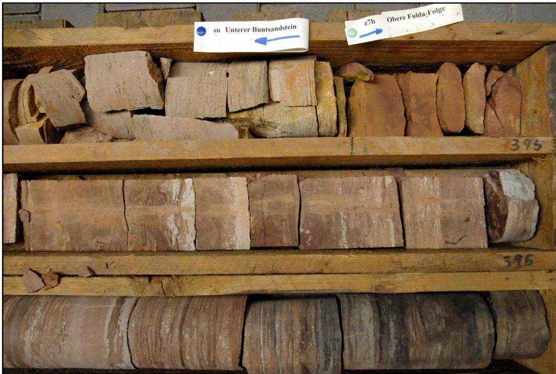
Abb. 25: Tonig-siltig-feinsandige Wechselfolgen im Übergangsbereich Zechstein – Buntsandstein (Bohrung Gelnhaar, TK 5620 Ortenberg)
