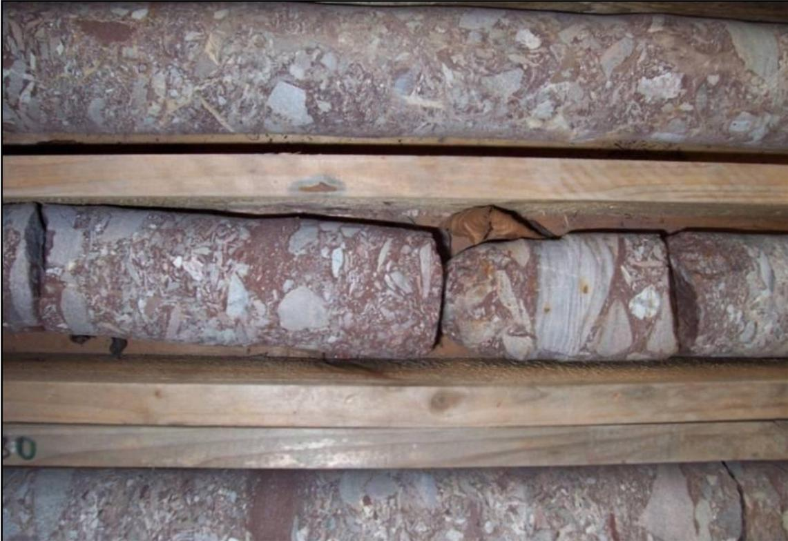
*Abb.8: Rotliegend-Konglomerat aus der Bohrung Rohrbach (TK 5024 Rotenburg a.d. Fulda)*
