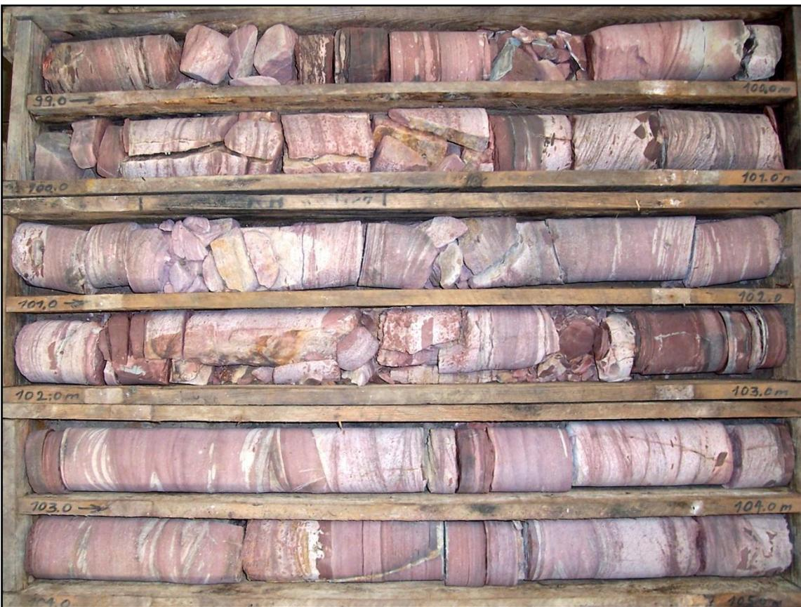
Abb.35: Detfurth-Wechselfolge (Bohrung Sterbfritz, TK 5623 Schlüchtern)
