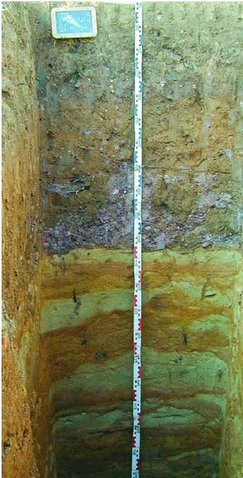
**Abb. 1.** Typischer Rigosol mit grobbodenreichem aufgefülltem Bodenmaterial bis 1 m u. Fl. über tertiärem Meeressand (Greifenberg).
